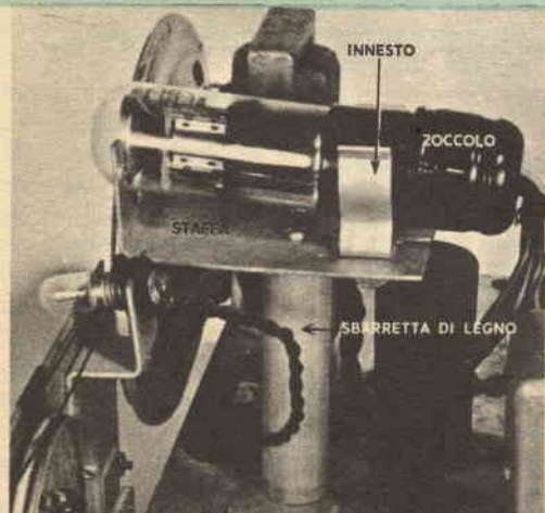
La valvola dell'occhio magico è tenuta a posto da una staffa posta in cima ad una sbarretta di legno.
