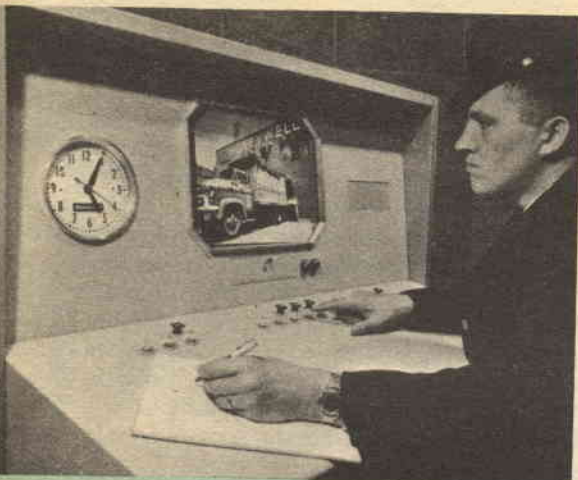
Apparecchi televisivi o macchine di ripresa cinematografica sono spesso inclusi in sistemi d'allarme anti-furto. La televisione offre una veduta istantanea su un monitor, mentre la registrazione su film può essere molto utile ai fini dell'identificazione o come prova.
