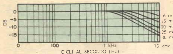
Questo diagramma mostra l'effetto di attenuazione di cavi di lunghezza diversa sulle frequenze elevate, quando vengono usati microfoni ad alta impedenza (25.000 Ω).
