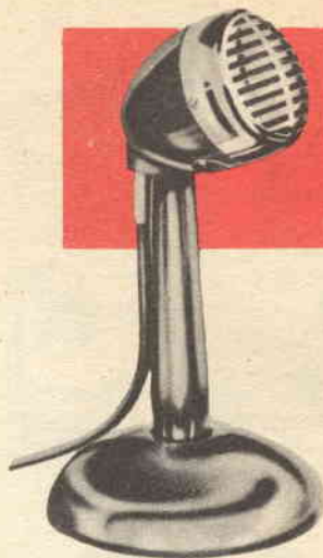
Tipo di microfono costruito per trasmissioni in banda singola; esalta la gamma di frequenze comprese fra 300 Hz e 3000 Hz in modo da dare la massima intelligibilità della voce.
